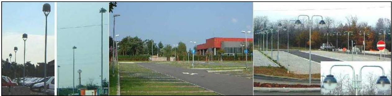
**Fig.5** – I primi tre parcheggi (conformi alla LR17/09) sono realizzati rispettivamente con apparecchi da arredo urbano, riflettori asimmetrici, apparecchi stradali. Nell'immagine a destra appare invece un parcheggio realizzato con sfere solo in parte schermate non conformi alla LR 17/09.
