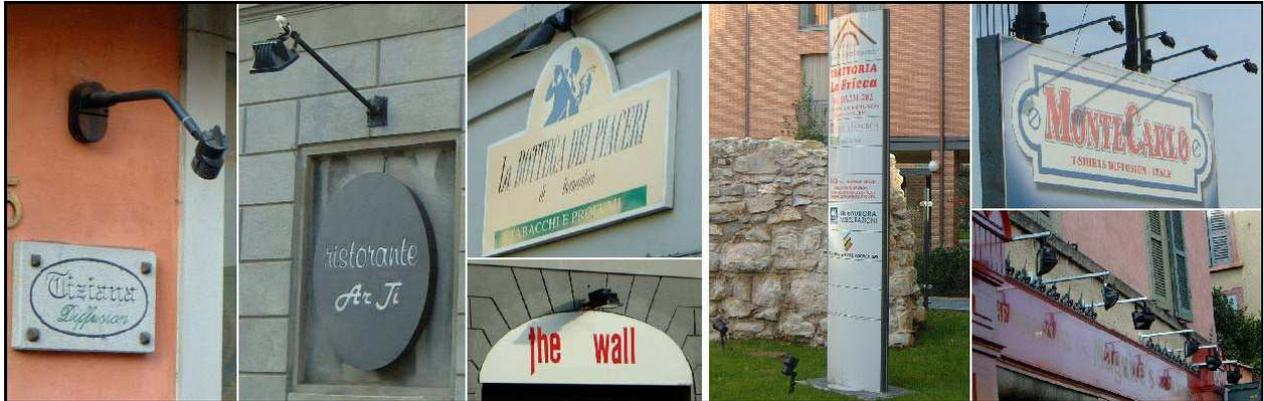
Fig.18 – Esempi di insegne prive di illuminazione propria. Le tre insegne di sinistra sono conformi alla L.r.17/09 in quanto illuminante dall'alto verso il basso con apparecchi orizzontali o inclinati ma con flusso intercettato dalla parete. A destra 2 insegne non conformi alla L.r. 17/09 in quanto la prima è illuminata dal basso e il pannello pubblicitario è illuminato dall'alto ma con corpi illuminanti inclinati con flusso non intercettato dalla sagoma.
