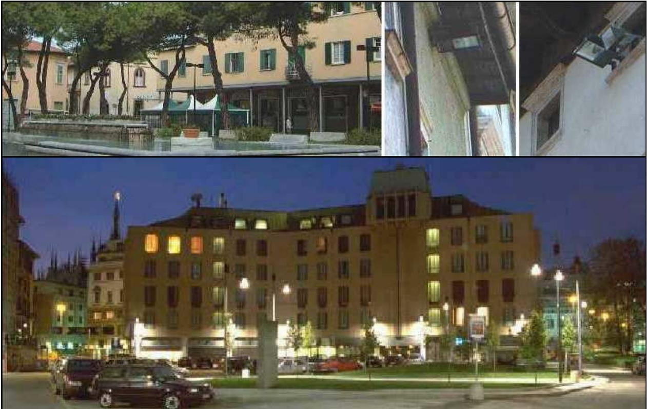
**Fig.8** – In alto a sinistra - Illuminazione conforme alla LR17/09 e sorgenti luminose poste in modo da non interferire con la chioma degli alberi. In alto a destra - Due esempi di illuminazione di centri storici con apparecchi sotto gronda (nell'immagine più a destra un apparecchio orizzontale affiancato ad uno inclinato probabilmente non conforme alla LR17/09)
