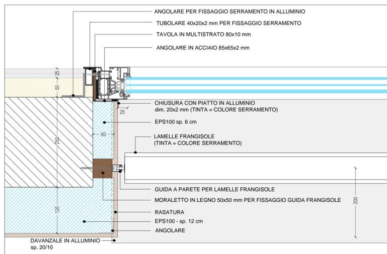
DETTAGLIO FINESTRA CON FRANGISOLE - SPALLETTA LATERALE
