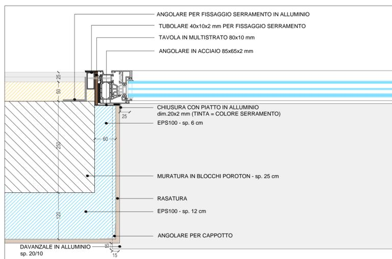
DETTAGLIO FINESTRA - SPALLETTA LATERALE
