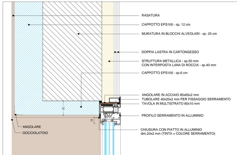
DETTAGLIO FINESTRA - SPALLETTA SUPERIORE
