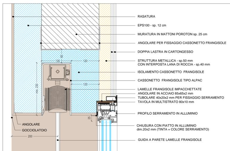
DETTAGLIO FINESTRA CON FRANGISOLE - SPALLETTA SUPERIORE
