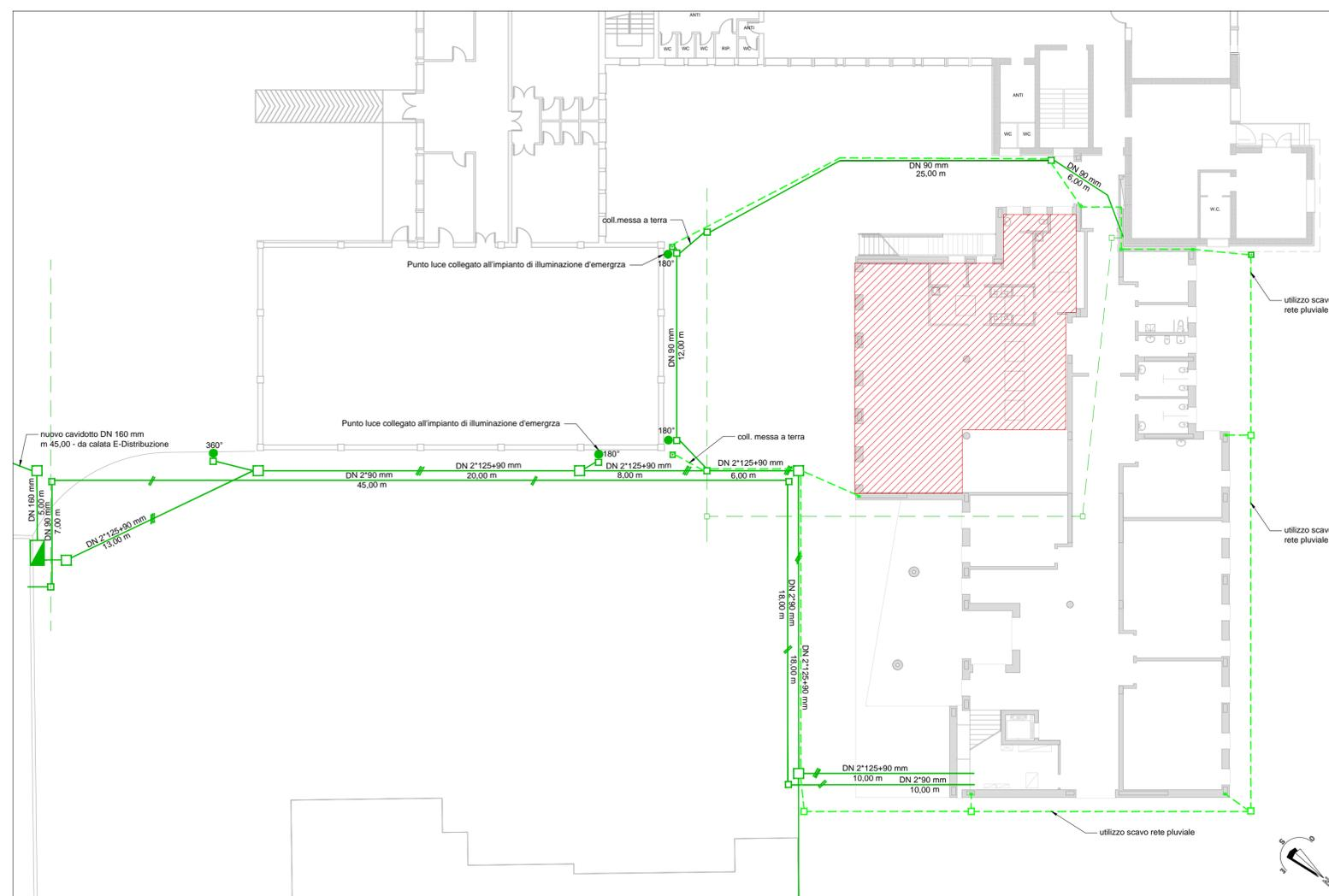
PLANIMETRIA DI DETTAGLIO CON EVIDENZIATA LA RETE ELETTRICA E SPECIALI DI PROGETTO
