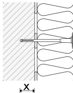
D ... Spessore minimo del materiale isolante 8 cm
